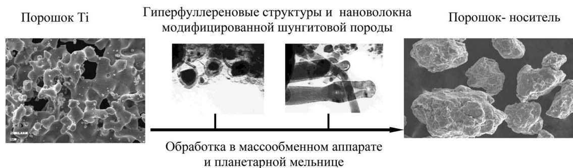
Рис. 4. Схема способа закрепления наноразмерных объектов на различных порошках носителях для последующего введения в расплав и данные МРСА после механического легирования в планетарной шаровой мельнице
