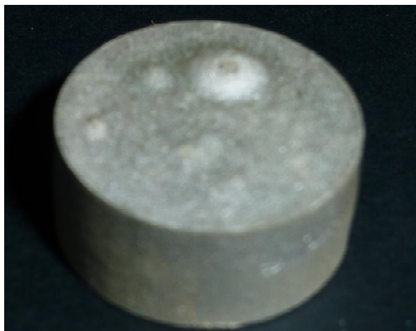
Рис. 7. «Вспучины» на поверхности образца серебра
