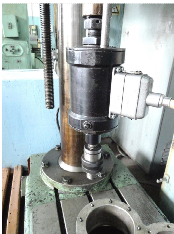
Рис. 3. Ультразвуковая резбонарезная головка с фокусирующей системой на станке 2Е53
