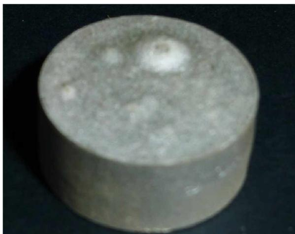
Рис. 7. «Вспучины» на поверхности образца серебра
