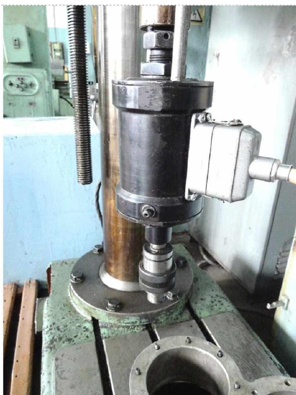
Рис. 3. Ультразвуковая резбонарезная головка с фокусирующей системой на станке 2E53
